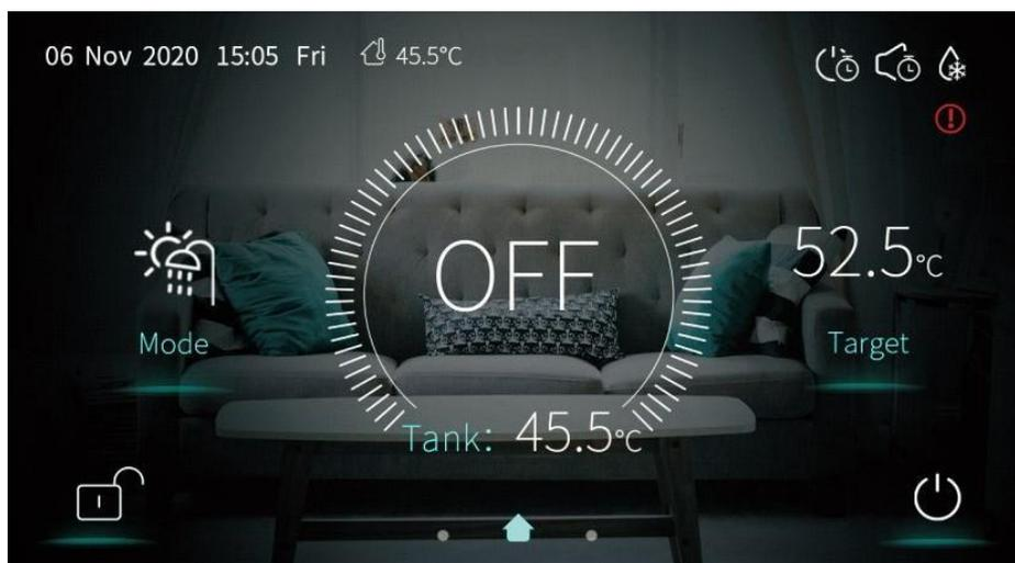
Beim Starten der Schnittstelle (Ein/Aus-Taste ist im blauen Status) kann durch Drücken der Ein/Aus-Taste die Maschine heruntergefahren werden.
