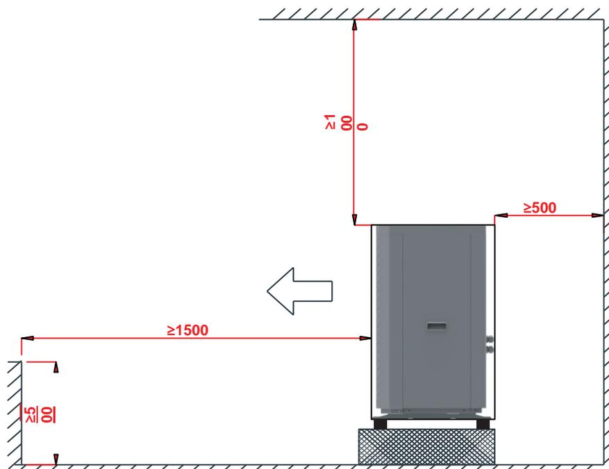
Bei nicht Beachtung der Abstände, kann die Effizienz der Wärmepumpe massiv gestört werden. Weiterhin kann die Funktion der Wärmepumpe beeinträchtigt werden. Im schlechtesten Fall ist mit dem Ausfall der Wärmepumpe zu rechnen. Die oben genannten Mindestabstände sollten schon wegen des Zuganges zur regelmäßigen Wartung und anfälligen Reparaturen eingehalten werden.
